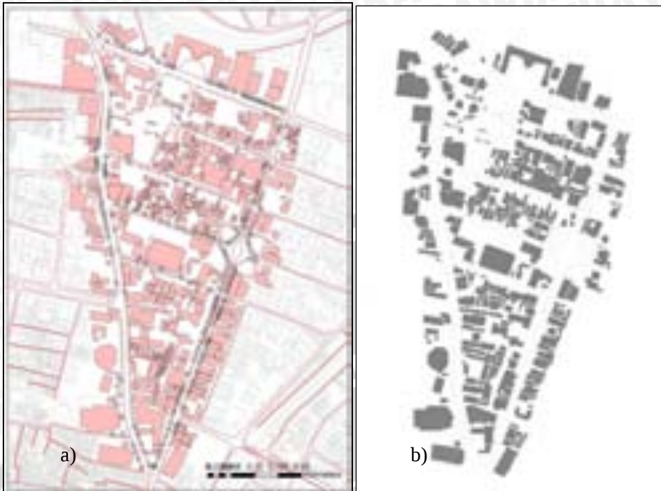
Gambar 4. 20 a) Data ArcGIS kawasan Tunjungan dan b) Input data bangunan pada ENVI-met
