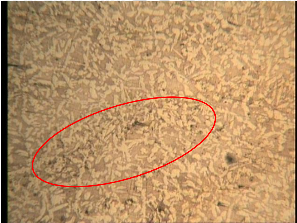
Gambar 4.6 Foto mikro produk cor dengan casting modulus 1,62 mm
