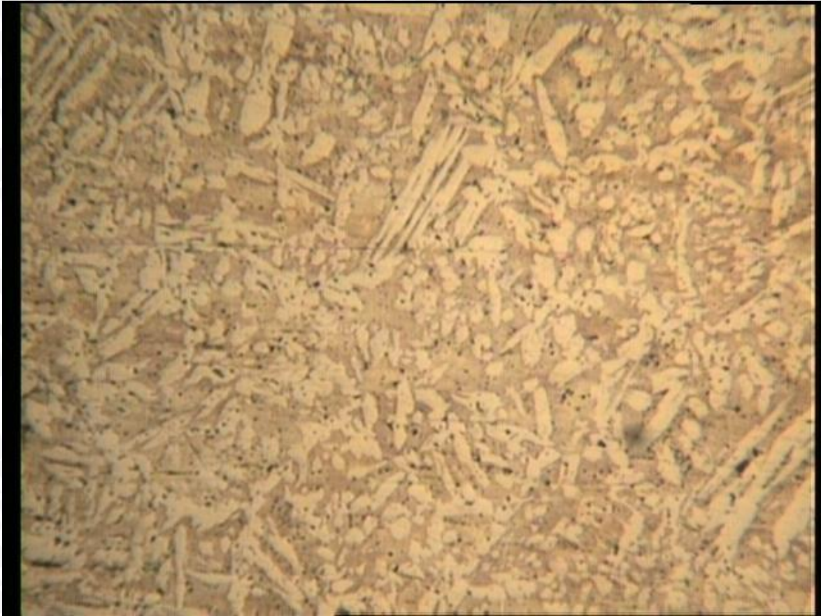
Gambar 4.8 Foto mikro produk cor dengan casting modulus 2,4 mm
