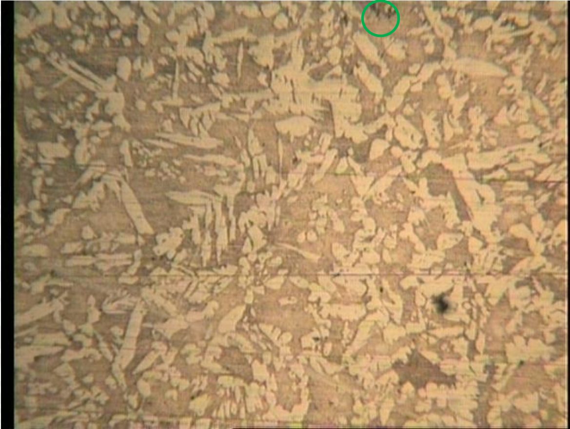
Gambar 4.7 Foto mikro produk cor dengan casting modulus 2,06 mm
