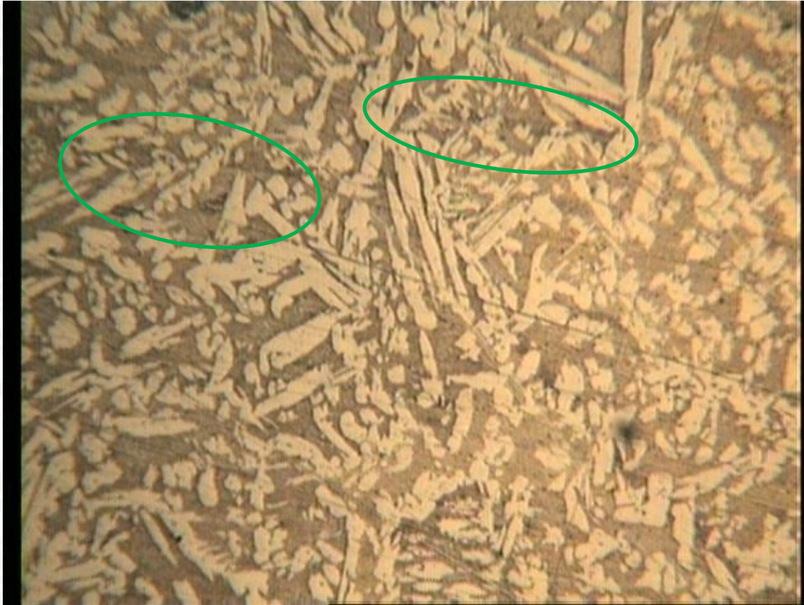
Gambar 4.9 Foto mikro produk cor dengan casting modulus 2,6 mm
