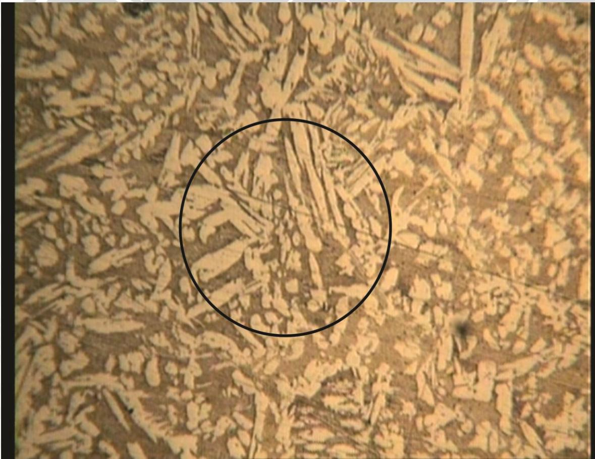
Gambar 4.2 Contoh perhitungan butir hasil pengecoran *brass* dengan nilai *casting modulus* 2,6 mm
