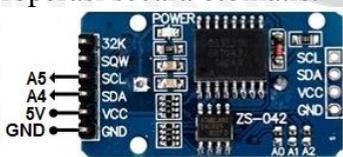
Gambar 14 Perancangan modul RTC DS3231
