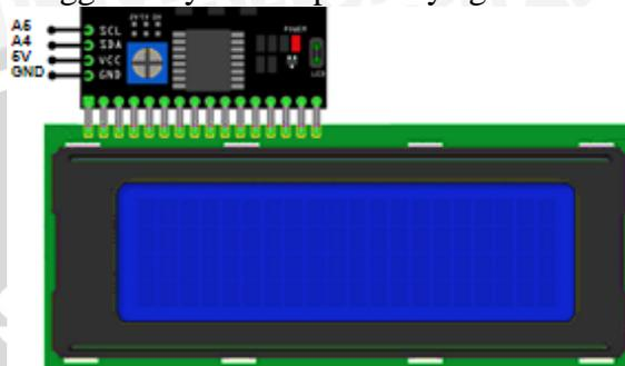
Gambar 15 Perancangan LCD dengan modul I2C
