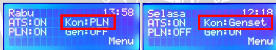
Gambar 4. 2 Tampilan LCD posisi beban dengan sumber PLN (kiri) dan beban dengan sumber genset (kanan)
