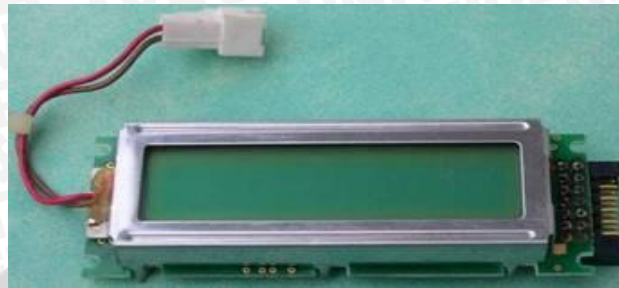
Gambar 2.7 Tampilan Fisik LCD M1632 15x2 Karakter Sumber: Dokumentasi, 2013
