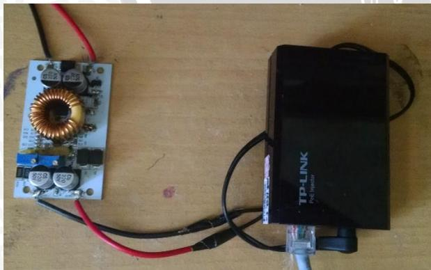
Gambar 3. 9 modul *boost converter* terhubung dengan PoE injektor
