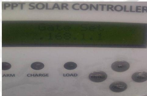
Gambar 3. 10 Pengaturan gateway pada MPPT
