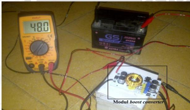
Gambar 3. 8 Pengaturan tegangan keluaran modul *boost converter*
