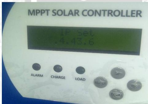
Gambar 3. 11 Pengaturan alamat IP pada MPPT
