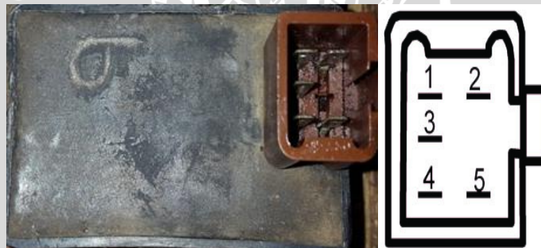
Gambar 3.8 Skema dan Alat CDI-AC
