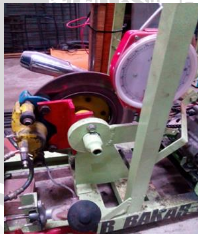
Gambar 3.3 Prony Disk Brake Sumber : Laboratorium Proses Produksi Jurusan Mesin Universitas Brawijaya (2016)
