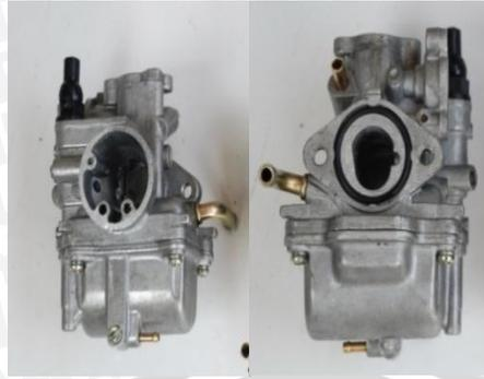
Gambar 2.4 Karburator sepeda motor
