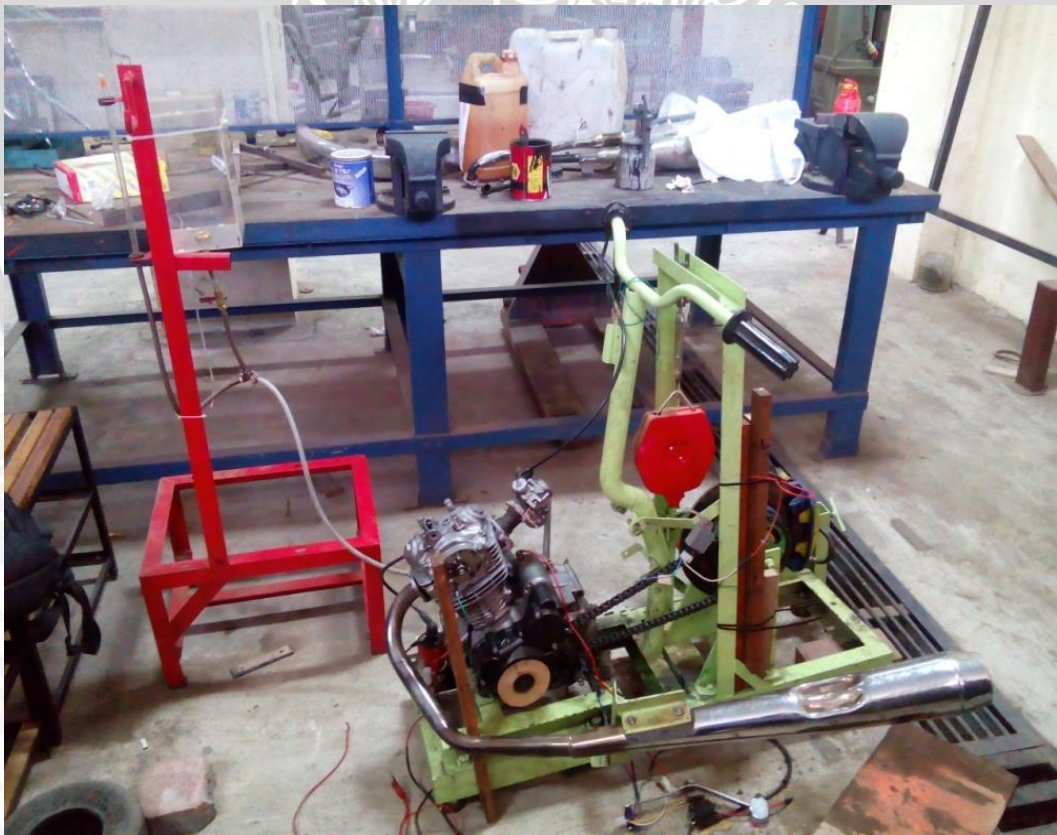
Gambar 3.1 Prototype motor bakar torak 6 langkah
