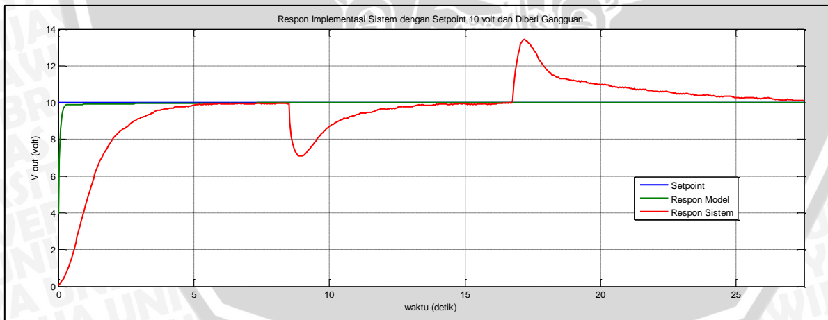
Gambar 4.21 Respon implementasi sistem dengan setpoint 10 volt dan diberi gangguan
