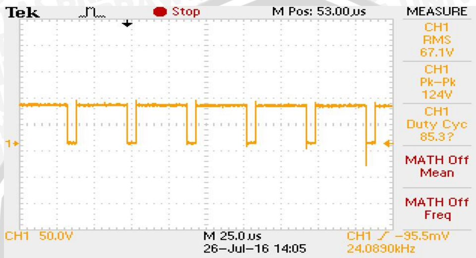
Gambar 5.2 Hasil pengujian Pembangkit sinyal picu pada nilai duty cycle 85.3%
