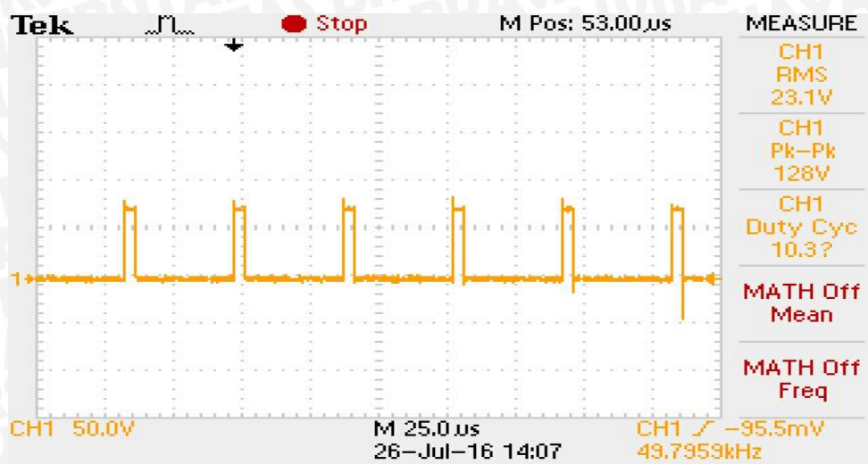
Gambar 5.4 Hasil pengujian Pembangkit sinyal picu pada nilai duty cycle 10.3%
