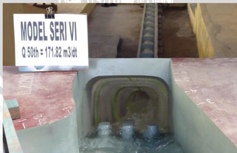
Kondisi aliran debit Q_{50} pada inlet terowong seri 6
