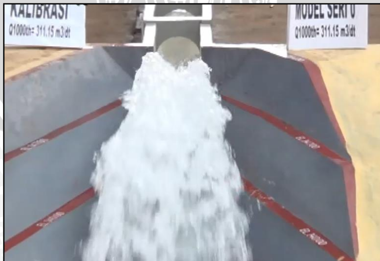
Kondisi aliran debit Q_{1000} pada peredam energi
