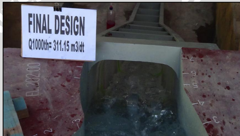
Kondisi aliran Q_{1000} di pada inlet terowong
