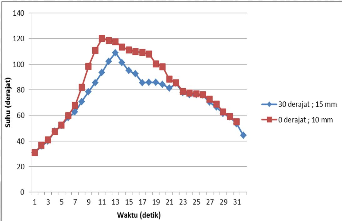
Grafik Distribusi Suhu saat Pengelasan pada spesimen dengan kekuatan tarik tertinggi yaitu sudut *chamfer* 30° dan *burn of length* 15mm dan pada spesimen dengan kekuatan tarik terendah yaitu sudut *chamfer* 0° dan *burn of length* 10 mm.
