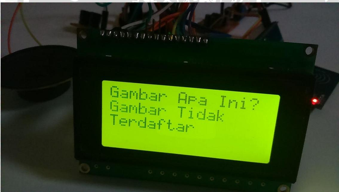
**Gambar 2.** Foto LCD Display Saat Pengidentifikasi Card Tag Tidak Terdaftar
