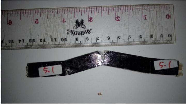
Gambar 4.3. Patahan spesimen uji *impact*
