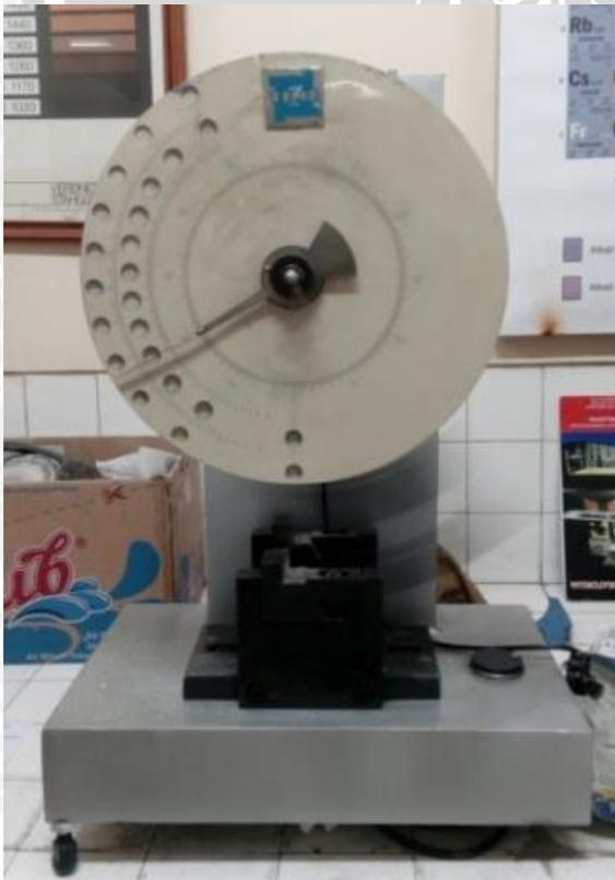
Gambar 2.10. Mesin uji *impact* sederhana (tipe *charpy*)
