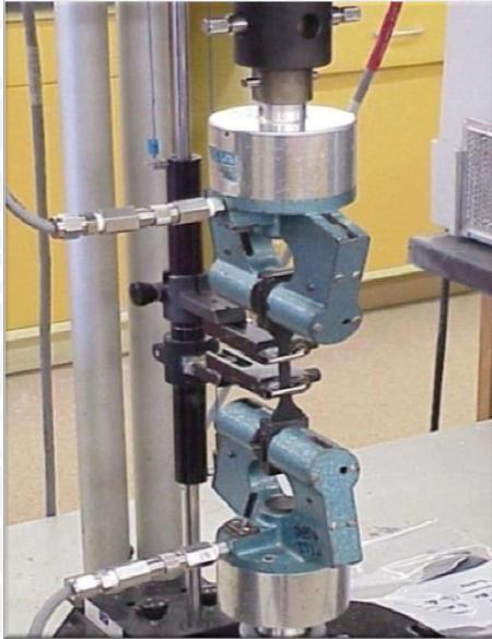
Gambar 2.8. Pengujian kekuatan tarik
