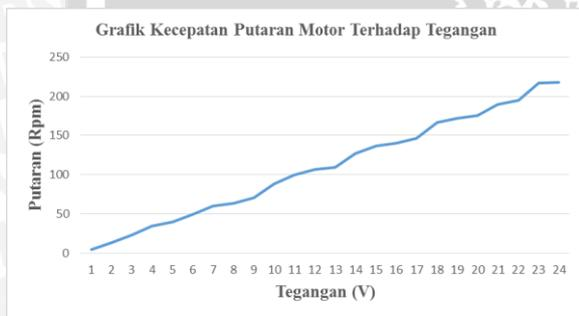
**Gambar 11.** Grafik Hubungan Kecepatan Putaran Motor dengan Tegangan
