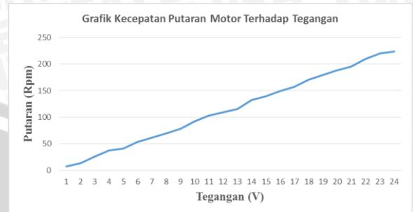
**Gambar 10.** Grafik Hubungan Kecepatan Putaran Motor dengan Tegangan
