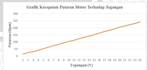
Gambar 9. Grafik Hubungan Kecepatan Putaran Motor dengan Tegangan
