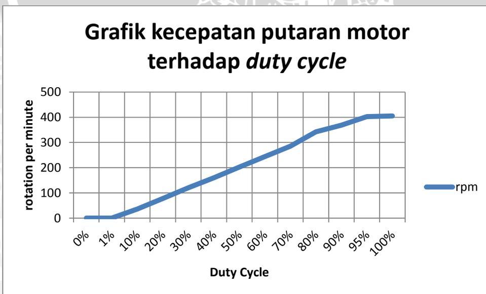
**Gambar 3.4** Grafik Hasil Pengujian Motor DC *Peristaltic Pump* 12V.
