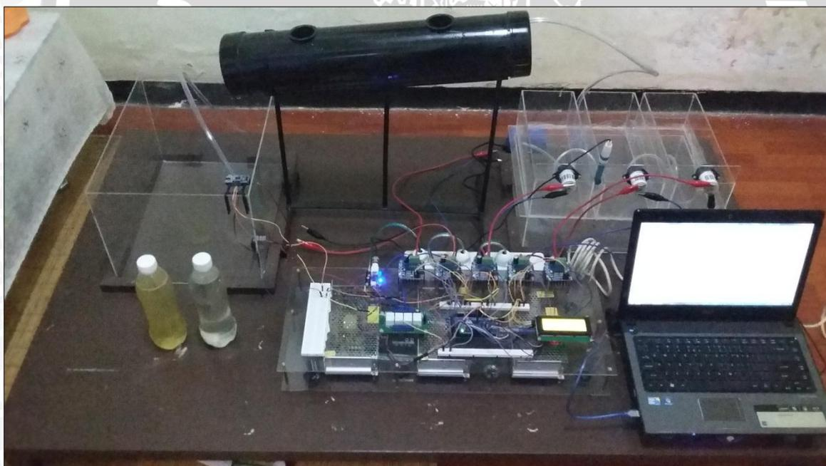
**Gambar 2** Alat Pengontrol Nutrisi pada Sistem Tomat Hidroponik Tampak Bagian Depan
