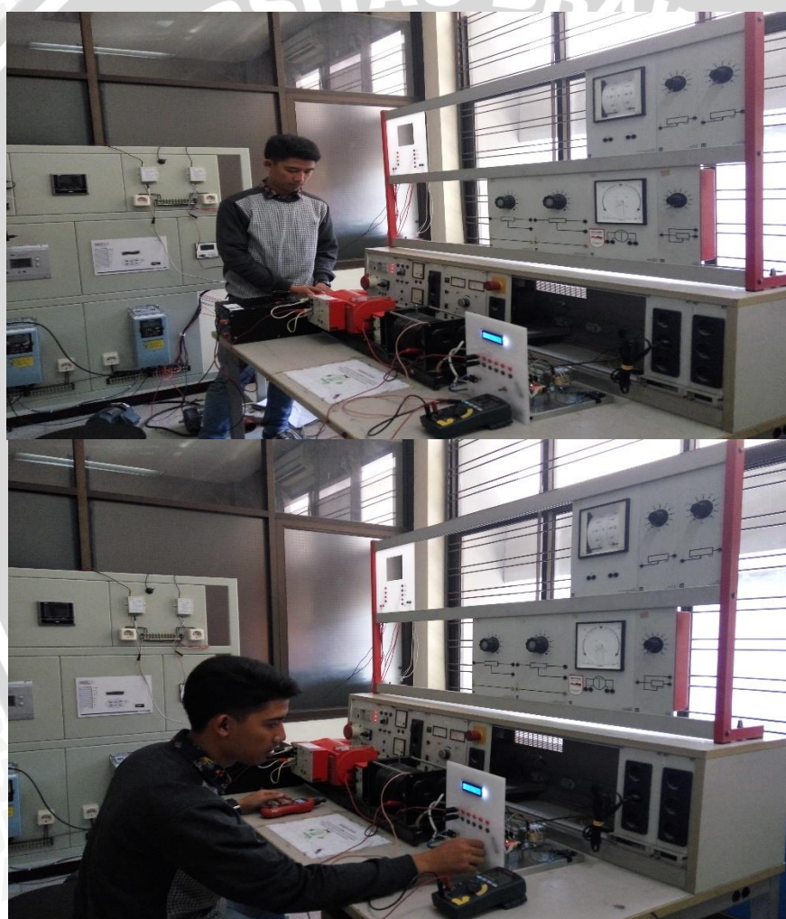
Gambar L 2. 4 Proses pengujian sistem keseluruhan dari control unit magnetic powder brake
