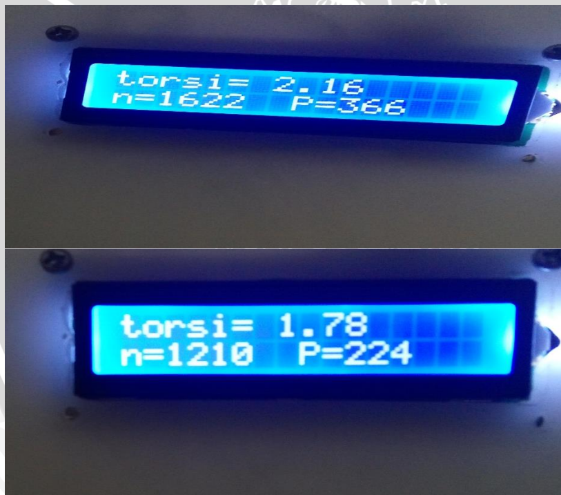
Gambar L. 2. 6 Tampilan hasil pengujian control unit magnetic powder brake pada LCD
