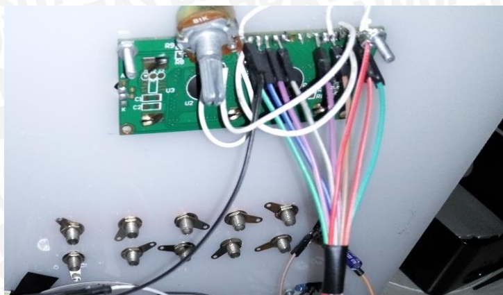
Gambar L 2. 3 Rangkaian LCD 16x2
