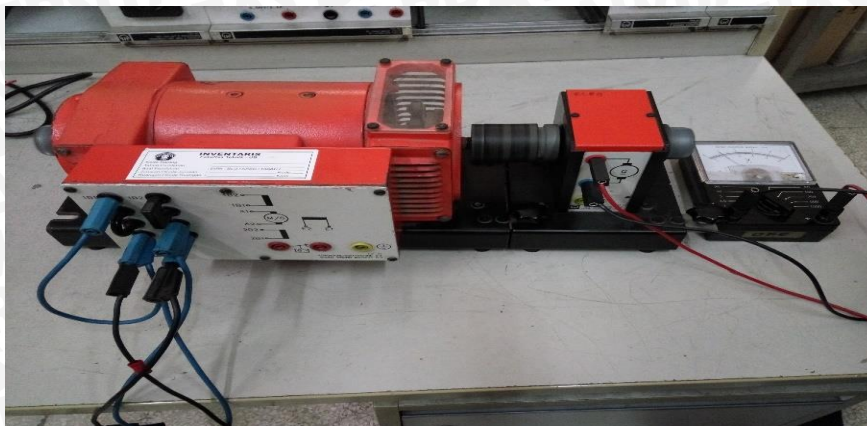
Gambar 5.5 Rangkaian pengujian tachogenerator sebagai sensor kecepatan
