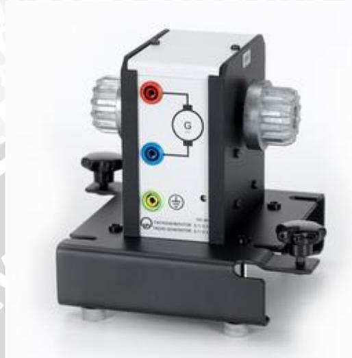
Gambar 2.12 Tachogenerator yang ada di Laboratorium Mesin Elektrik
