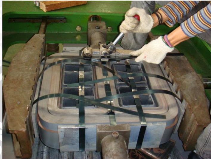
Gambar 4.4 Proses pengikatan core
