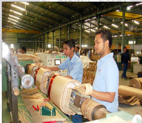
Gambar 4.5 Proses pembuatan coil
