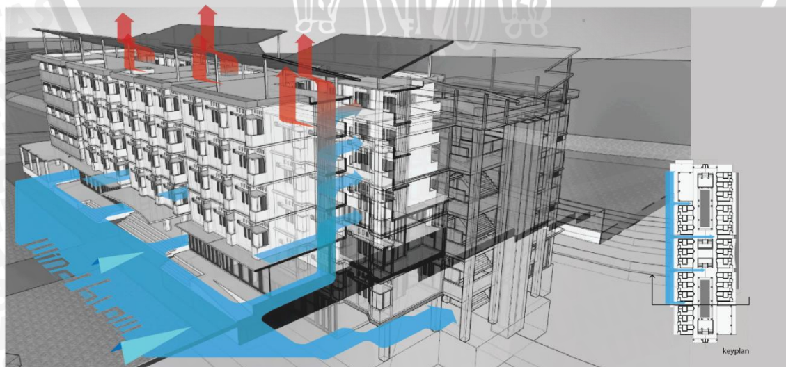
Gambar 4. 58 Aliran angin yang masuk melalui desain lantai dasar yang tidak tertutup mengalir ke atas dengan memanfaatkan panas dari atap
