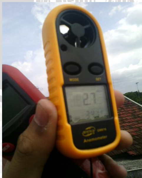
Gambar 5.2 Pengukuran angin dengan anemometer.
