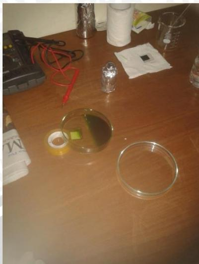
Gambar 4. 9 : Proses Perendaman Lapisan  $\text{TiO}_2$  dalam Larutan *Dye*
