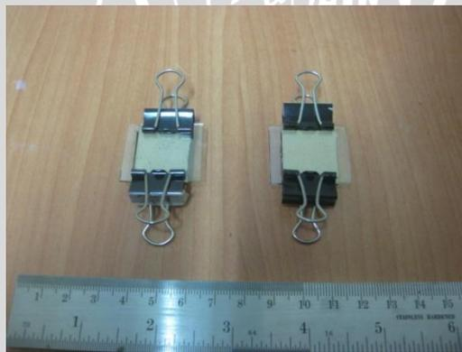
**Gambar 4. 12** : Hasil Akhir Rancangan DSSC Berbasis *Dye* Dari Bahan Hasil Ekstraksi Daun Pepaya dan DSSC Berbasis *Dye* Dari Bahan Hasil Ekstraksi Daun Jarak Pagar
