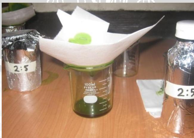
**Gambar 4. 5 :** Proses Penyaringan Dye
