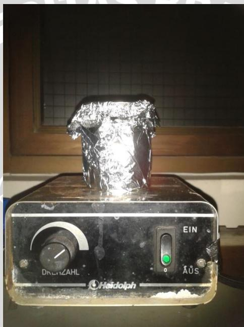
**Gambar 4. 4:** Proses Homogenisasi Klorofil Dengan Pelarut
