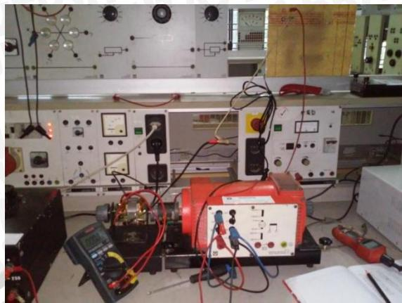
Gambar 7. Pengujian generator DC penguat terpisah
