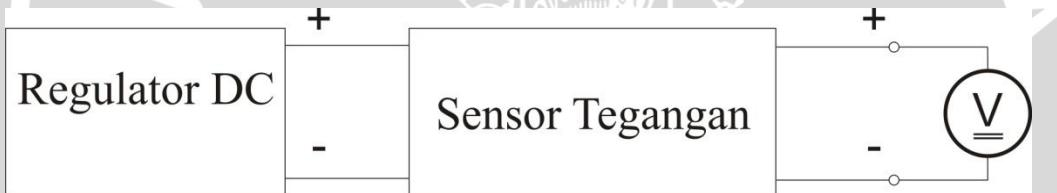
Gambar 4. 14 Rangkaian pengujian sensor tegangan
