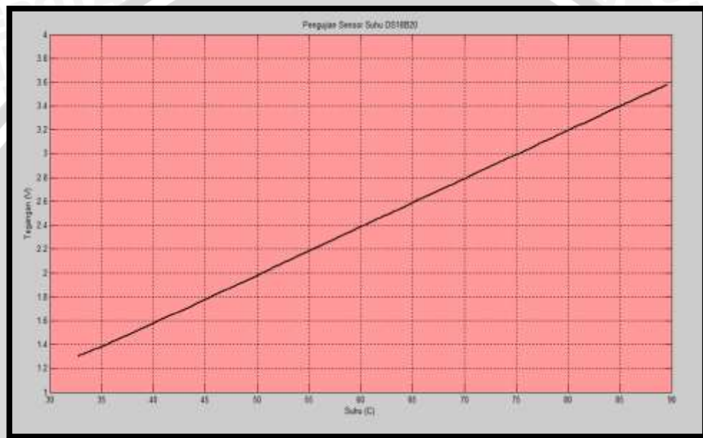
Gambar 3.11 Grafik perubahan tegangan dengan pembacaan sensor suhu DS18B20.
