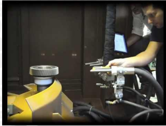
Gambar 2.12 Pengaturan alat tembak ke spesimen oleh operator Sumber : Norblastsrl (2013 : youtube)
