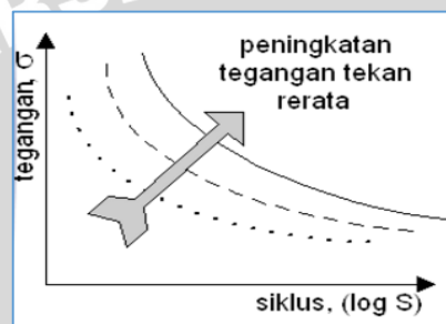
Gambar 2.22. Peningkatan umur lelah pada kurva S-N Sumber : Arbintarso (2015)
