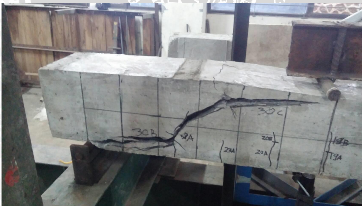
Keterangan : Runtuh geser pada balok Hollow core 9 cm
