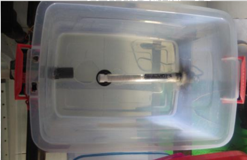
Pemasangan Heater pada tangki aktuator
