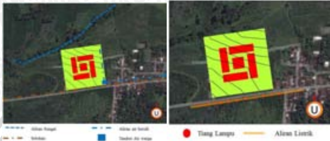
Gambar 4. 53 Analisis Utilitas pada Tapak
