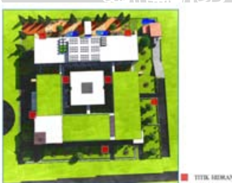
Gambar 4. 83 Titik Hidran Pada Bangunan
