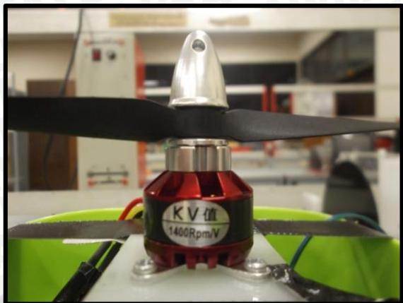
Gambar 3.7 Motor DC *Brushless* 1400kV (Perancangan, 2016)
