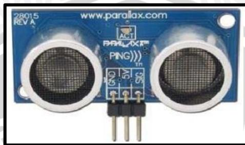
Gambar 2.4 Sensor Ultrasonik PING)))
