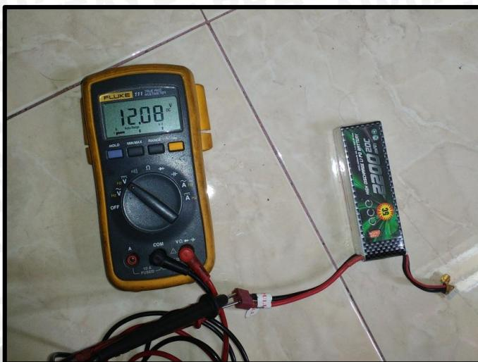
**Gambar 4.1** Pengujian Catu Tegangan Baterai Li-po 11,1 V 2200 mA (Pengujian, 2016)
