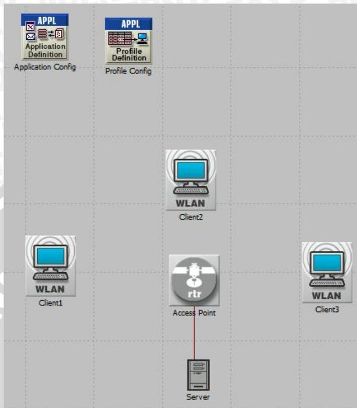
**Gambar 4.1** Konfigurasi *Video Conference* pada Jaringan *Wireless LAN* dengan Media IPv6
