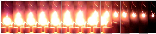
Gambar 4.3 Visualisasi api pada minyak jarak + Rh 0.01%
