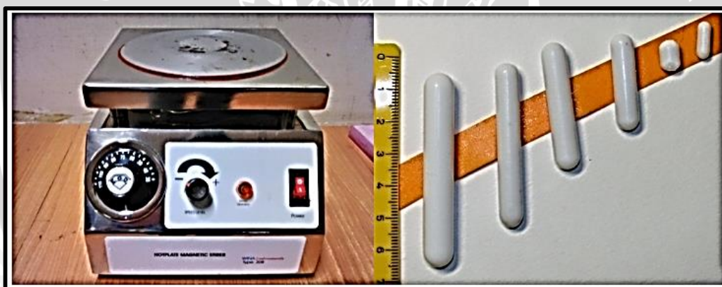
Gambar 2.9 Magnetic Stirrer (Kiri) dan Magnetic Stir Bar (Kanan). Sumber: Laboratorium Elektronika Teknik Elektro FTUB.
