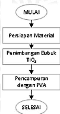
Gambar 2. diagram alur pembuatan pasta TiO<sup>2</sup>
