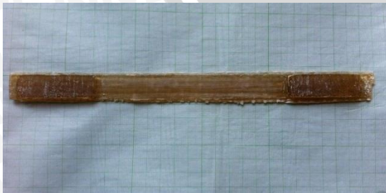
Gambar 4.2 Hasil spesimen uji tarik
