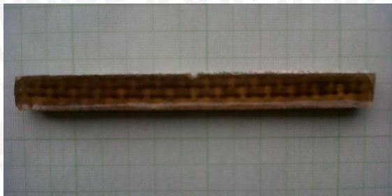
Gambar 4.3 Hasil spesimen uji impact
