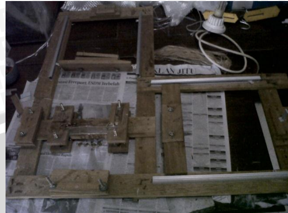
Gambar 2 Instalasi pre tension .
