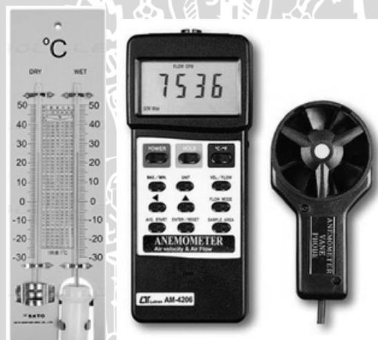
**Gambar 3.1 Thermometer dan anemometer yang digunakan**
