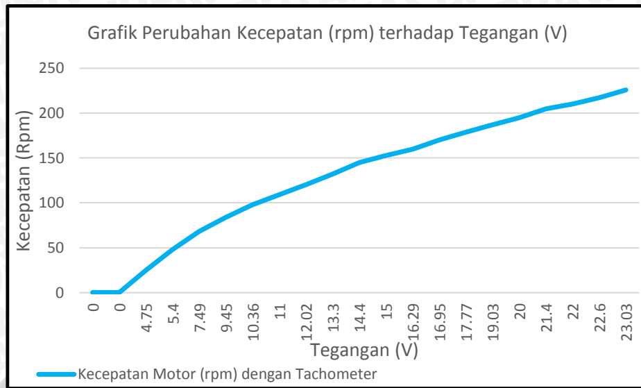
Gambar 3.2 Grafik perubahan kecepatan motor BLDC(rpm) terhadap tegangan(v)
