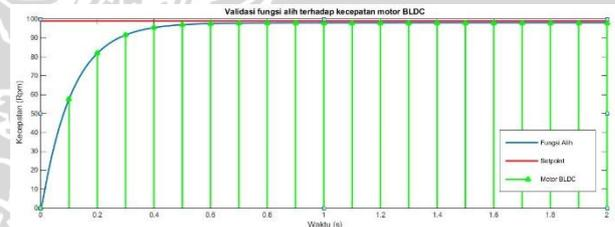
Gambar 5 Respon *unit step*, fungsi alih dan kecepatan Motor BLDC
