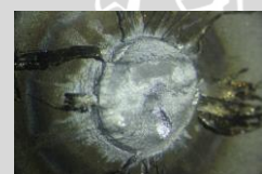
Arus Pengelasan 104 Ampere
