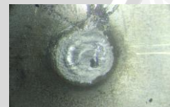
Arus Pengelasan 84 Ampere
