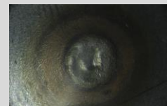
Arus Pengelasan 104 Ampere
