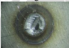
Arus Pengelasan 74 Ampere
