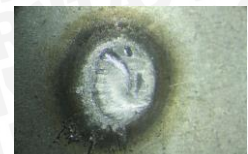
Arus Pengelasan 104 Ampere
