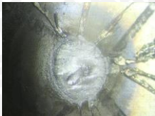
Arus Pengelasan 94 Ampere
