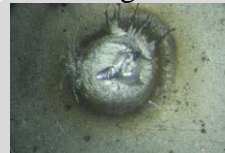
Arus Pengelasan 74 Ampere
