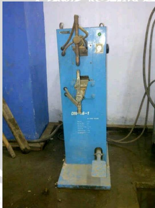
Gambar 3.1 Mesin Las Titik
