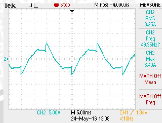
Gambar 4.2. Bentuk Gelombang arus pada beban non linier dengan THDi 27,415%
