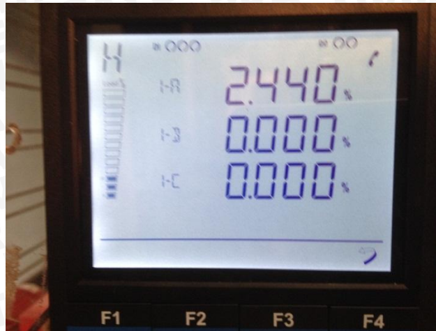
Gambar 4.6 Beban linier dengan THD 2,098%
