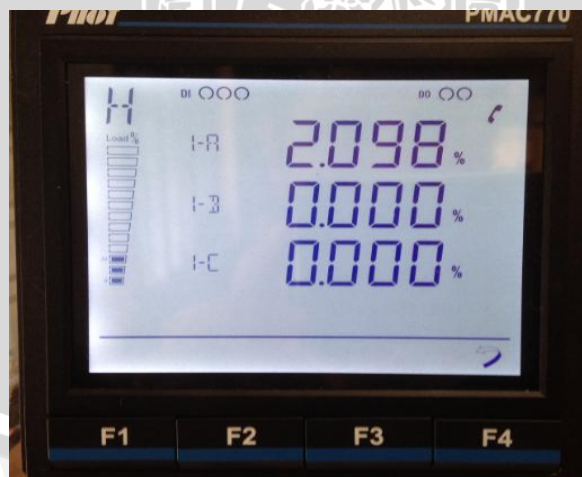
Gambar 4.5 Beban linier dengan THD 2,440%
