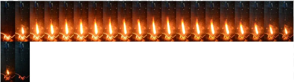
12. Dimensi nyala api C70 (crude 70% + etanol 30%) pada tekanan 5 atm
