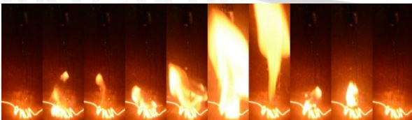
13. Dimensi nyala api C60 (crude 60% + etanol 40%) pada tekanan 1 atm
