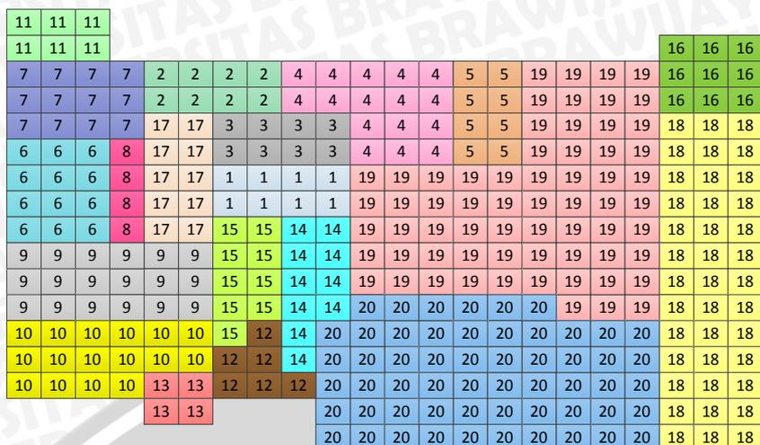
Gambar 4.32 Layout usulan A3 PT Indana Paint dengan Algoritma CORELAP
