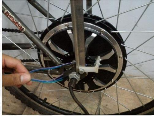
Gambar 3.20 Pembuatan modul motor BLDC dan rotary encoder
