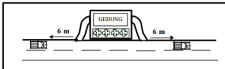
Gambar 2. 9 Larangan parkir di akses bangunan gedung
